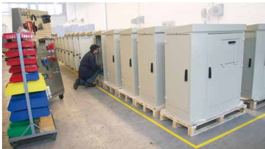
Assemblage traffic control cabinets bij ITEQ Industries
