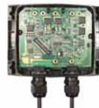
De creditcard formaat junction box (onder) en de MCU (rechts), beide ontwikkeld door het Veldhovense bedrijf Alrack.
